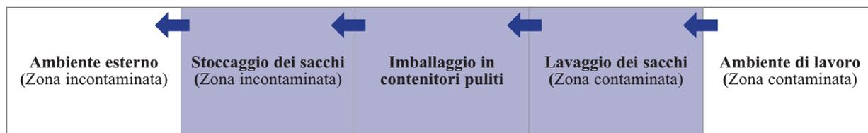
Figura 2 – Unità di decontaminazione dei materiali (UDM) a tre locali. (Fonte: S. Clarelli, *La gestione tecnica del rischio amianto, Tecniche Nuove, 2020*)
