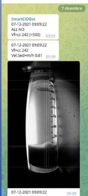
Al termine del ciclo di rilevazione i dati vengono registrati sulla memoria microSD della **smartCID Vf** e inviati sia sul database che con Telegram sul pc, smartphone, tablet.
