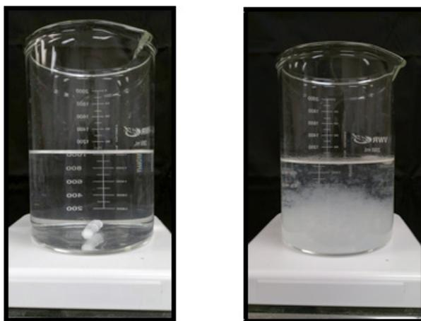
Figura 1. Formazione del catalizzatore al variare del pH (a sinistra soluzione a  $pH > 11$ , a destra soluzione a pH neutro)
