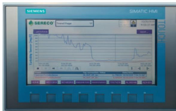
Figura 9 – Reazione al disturbo continuativo di TSS, il filtro contiene il valore di TSS limitandone l'uscita
