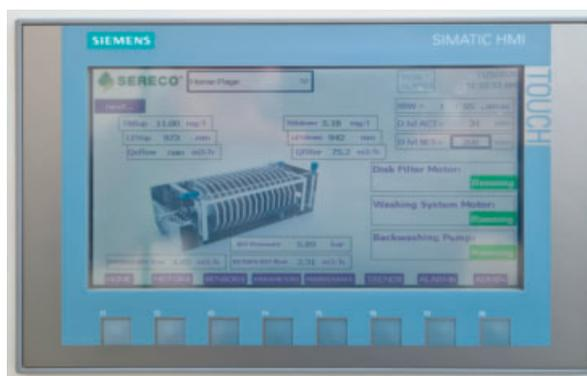
Figura 7 – Valore massimo di 3.1%: portata di controlavaggio  $2.31 \text{ m}^3 \text{ h}^{-1}$  su portata filtrata di  $75.2 \text{ m}^3 \text{ h}^{-1}$
