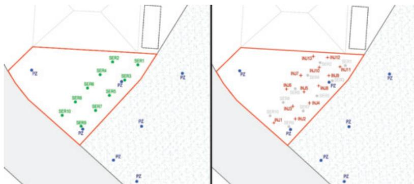
Piezometri di iniezione Ivey-sol® (sinistra) e punti iniezione Provect-OX® (destra)
