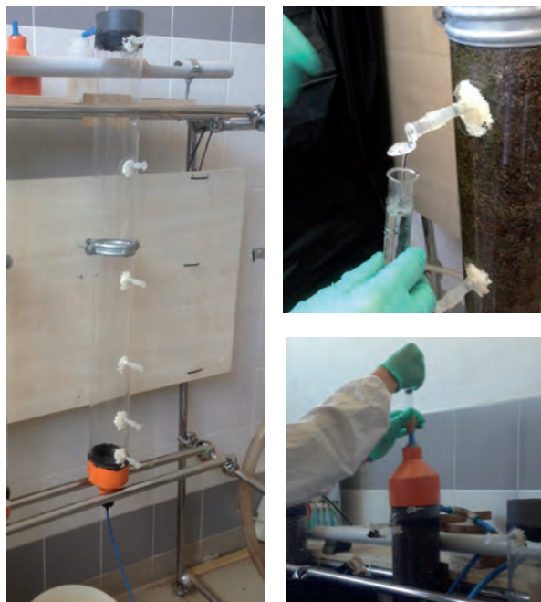
Figura 1 – Vista dell'impianto e particolari delle fasi di campionamento del liquido e del gas
