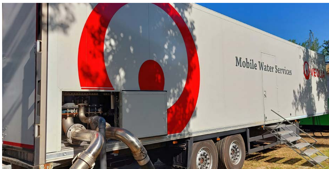
Figura 1. Unità mobile con tecnologia ad osmosi inversa installata presso Acquevenete.
