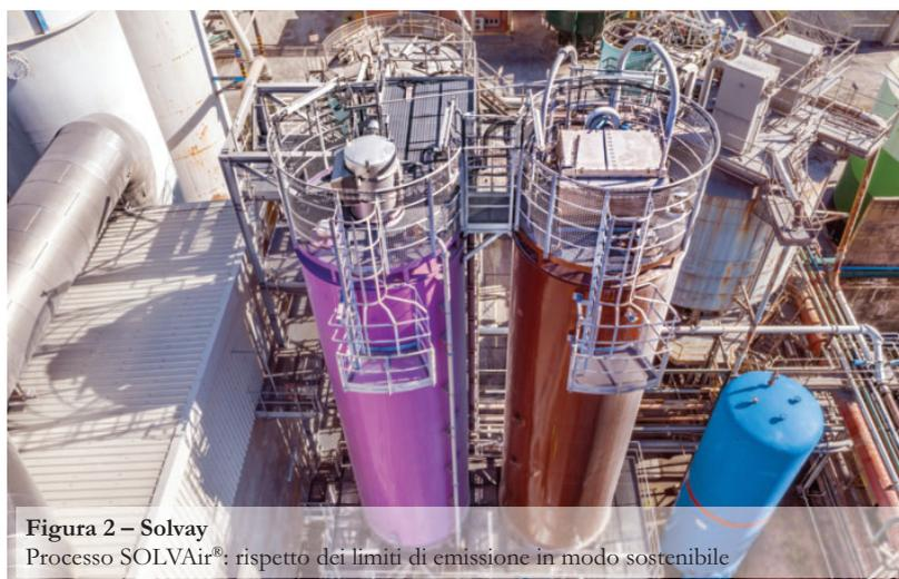
tra i 140 e i 190 °C). Il bicarbonato si trasforma pressoché istantaneamente in carbonato di sodio, liberando nel contempo acqua ed anidride carbonica. Questo rilascio di sostanze in fase gassosa produce due effetti principali:
