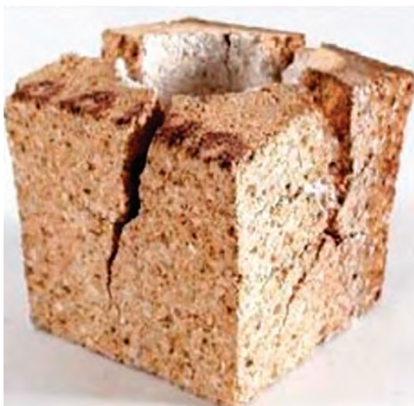
Figura 2 Collasso del refrattario per l'infiltrazione della scoria
