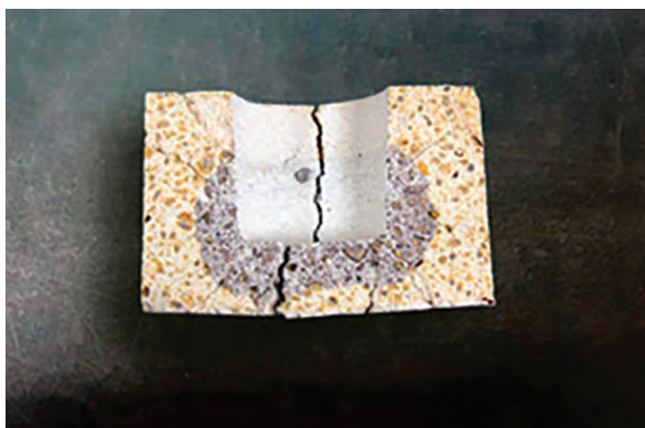
Figura 1 A sinistra: alcali cup test "provino"; a destra: infiltrazione alcalina e conseguente collasso del provino
