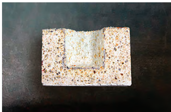
Figura 1 A sinistra: alcali cup test "provino"; a destra: infiltrazione alcalina e conseguente collasso del provino
