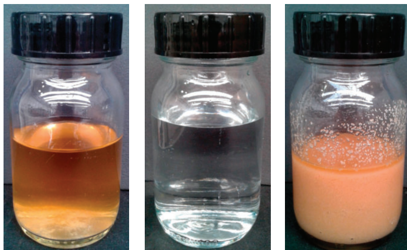
Figura 4: Tal quale, distillato e concentrato del refluo ricco in cloruri
