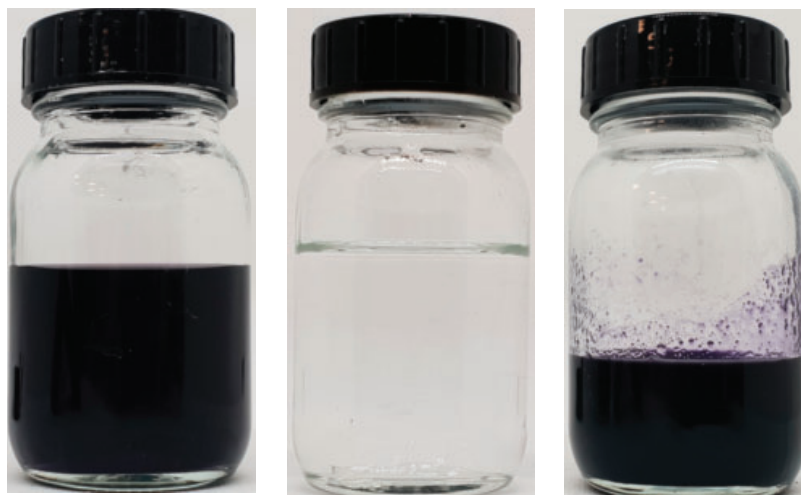
Figura 5: Tal quale, distillato e concentrato dell'acqua di processo trattata nel raschiato
