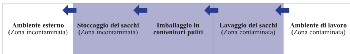
Figura 2 – Unità di decontaminazione dei materiali (UDM) a tre locali. (Fonte: S. Clarelli, La gestione tecnica del rischio amianto, Tecniche Nuove, 2020 )
