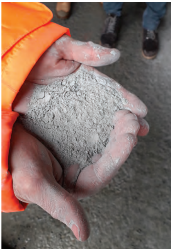
Figura 3 – Prodotto frantumato di granulometria sub-micronica
