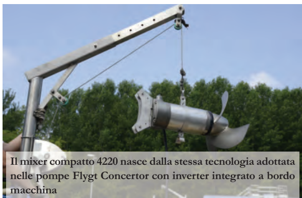
Il mixer può essere installato a vasca piena in poche ore utilizzando la stessa attrezzatura già presente in vasca ed utilizzata per altri mixer
