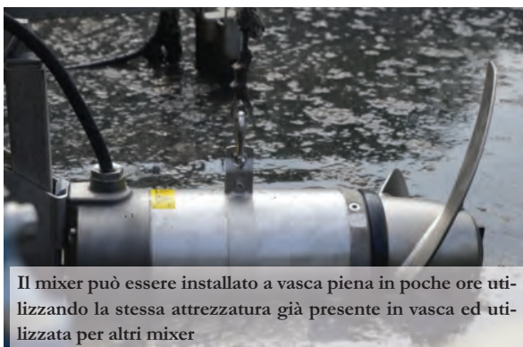
Il mixer compatto 4220 nasce dalla stessa tecnologia adottata nelle pompe Flygt Concertor con inverter integrato a bordo macchina
