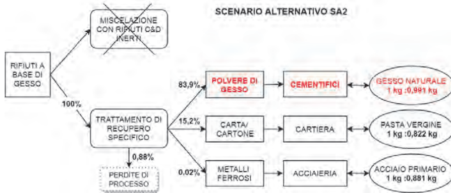
Figura 2/c – Sistema di riferimento per lo scenario alternativo SA2, con indicazione dei prodotti primari evitati
