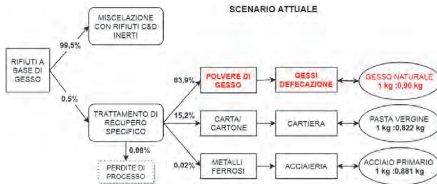
Figura 2/a – Sistema di riferimento per lo scenario attuale, con indicazione dei prodotti primari evitati
