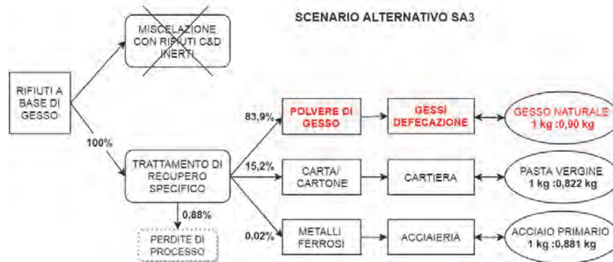
Figura 2/d – Sistema di riferimento per lo scenario alternativo SA3, con indicazione dei prodotti primari evitati
